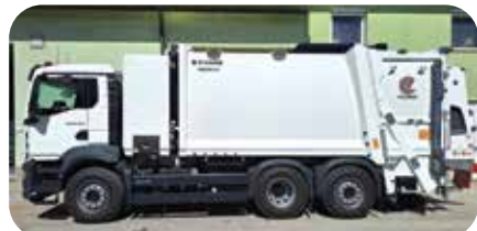
Novo triosno smetarsko vozilo Komune Radovljica združuje zbiranje odpadkov in pranje zabojnikov z vročo vodo.
